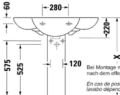
Bei Montage mit Säule ist die Montagehöhe nach dem effektiven Mass der Säule festzulegen.
