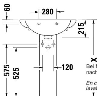
Bei Montage mit Säule ist die Montagehöhe nach dem effektiven Mass der Säule festzulegen.
